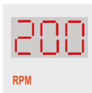
O manuseio do eixo de transmissão é realizado através do parâmetro “Velocidade de rotação” (RPM, Rotations Per Minute). Para obter informações detalhadas sobre o ajuste dos parâmetros, consulte → Capítulo 6.3 “Ajustar, ativar e desativar parâmetros” na página 64.
