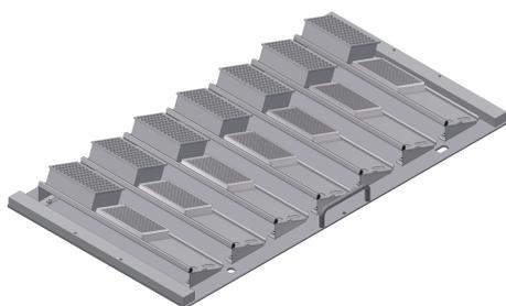
Bandeja com conjuntos de fixação de garras inclinadas em um ângulo de 20° (incubação angular): A barra de fixação inclinada é uma chapa em forma de mesa com dois perfis. O perfil inferior é uma barra angular (3). O perfil superior é um perfil em U, no qual é inserido um cordão de borracha celular (2). Existem dois espaçadores (1) no perfil superior para posicionar as microplacas ou placas de poços profundos.
