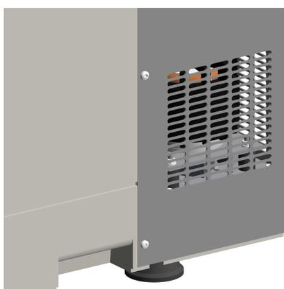
O dispositivo possui saídas de ar nos dois lados e na parte de trás da carcaça. Para garantir que o gás de saída possa escapar sem impedimentos e que os componentes não superaqueçam, deve-se ter cuidado ao instalar o dispositivo para que essas saídas de ar permaneçam livres.
