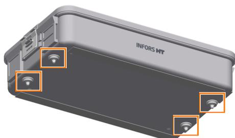
A caixa para microplacas é fixada na bandeja com quatro parafusos Phillips. Na entrega, os parafusos de fixação estão cobertos com porcas de capa de plástico. Elas devem ser removidas antes da montagem.
