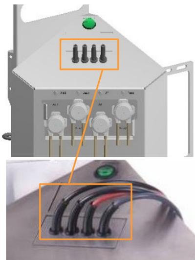
L'appareil de base est équipé et configuré pour la mesure de la température, du pH, du pO<sub>2</sub> et la détection de mousse (« anti-mousse ») par défaut. Cela veut dire que la sonde température et les câbles des sondes pH, pO<sub>2</sub> et antimousse sont toujours présents. Les sondes appropriées ne sont pas incluses dans les packages standard, mais sont disponibles séparément.
