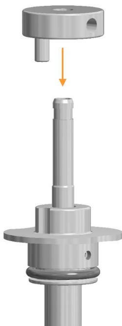
5. Pousser l'anneau manuel sur le diffuseur de gaz, jusqu'en butée (pas au-delà).
