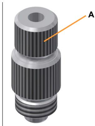
Une fois la vis à tête creuse (A) dévissée, le composant de Ø 8 mm peut être inséré dans le manchon de blocage ou retiré. Le serrage de la vis à tête creuse permet de le fixer dans le manchon de blocage.
