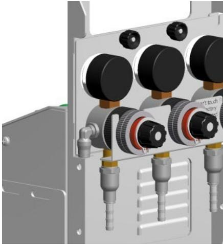
Les raccordements de gaz se trouvent en haut à l'arrière de l'appareil de base et sont étiquetés avec le gaz correspondant. Chaque raccordement de gaz dispose d'une vanne de retenue, d'un manomètre et d'un réducteur de pression. Le nombre de raccordements varie selon la configuration.
