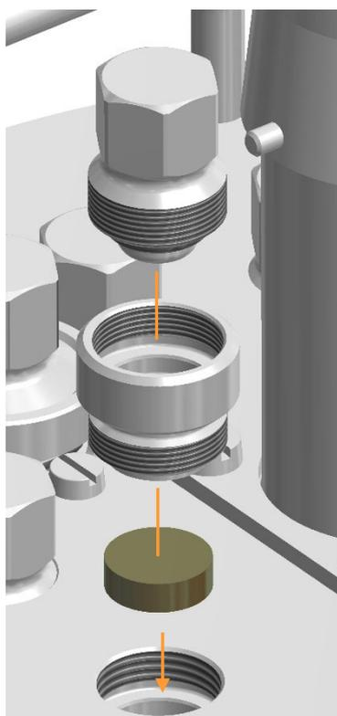
1. Vérifier qu'aucun joint torique ne se trouve dans le port du couvercle de la cuve ; le cas échéant, enlever le joint torique.
