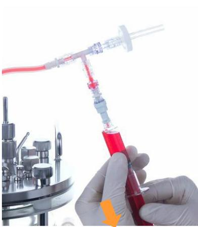
6. Tirer le piston de la seringue en arrière pour prélever le volume d'échantillon souhaité.
