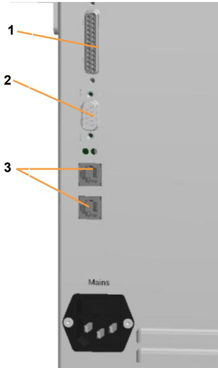
Les raccordements des signaux de données suivants (de haut en bas) se trouvent au-dessus de la prise secteur :
