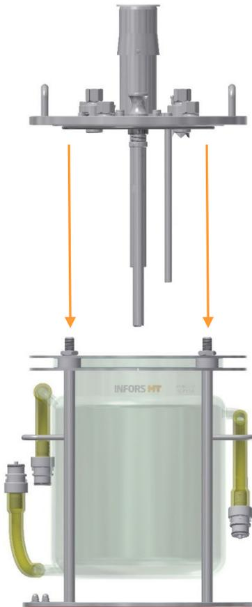
1. Positionner avec précaution le couvercle correctement orienté.
