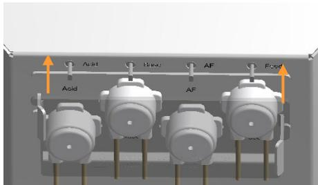
1. Extraire la plaque de recouvrement des pompes de son support et la retirer.
