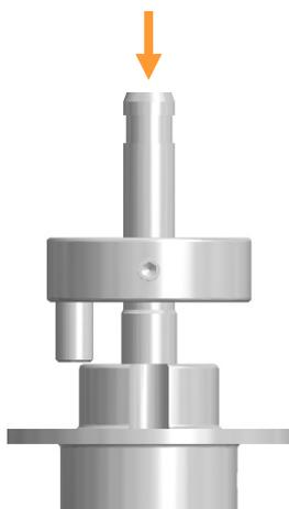
3. Enficher le tuyau en silicone sur le diffuseur de gaz.
