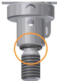
4. Contrôler le joint torique de l'arbre d'entraînement pour voir s'il est intact et bien positionné. Au besoin, l'ajuster ou le remplacer.
