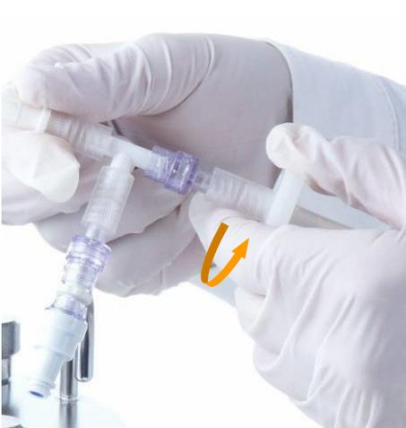
4. Tourner le filtre stérile à la main, avec précaution, dans le sens des aiguilles d'une montre.
