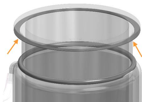
2. Placer la bague d'amortissement noire sous le collier de la cuve.
