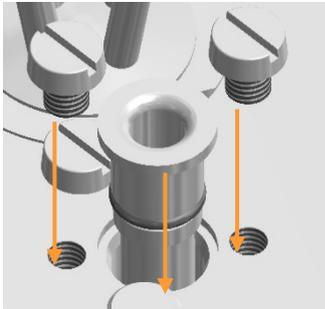
1. Insérer le doigt de gant avec le joint torique fixe dans le port de 10 mm.
