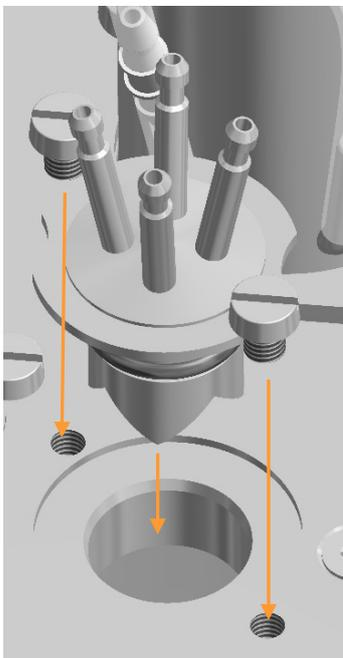
1. Insérer l'insert d'ajout quadruple avec le joint torique fixe dans le port.
