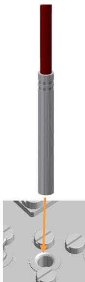
1. Introduire simplement la sonde dans le doigt de gant du couvercle jusqu'à la butée.
