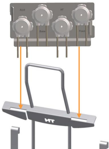
3. Insérer la platine avec les têtes de pompes sur le support de flacons de réactif et de pompes.
