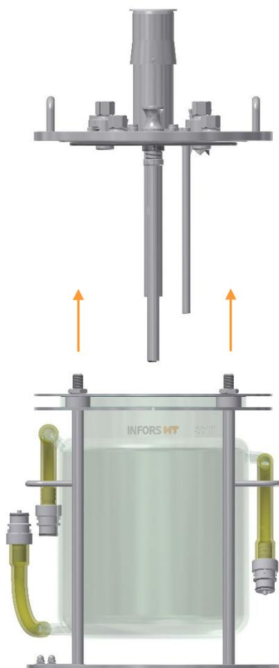
3. Soulever délicatement le couvercle verticalement par rapport la cuve jusqu'à ce que l'arbre d'agitation et éventuellement d'autres composants longs ne puissent plus entrer en contact avec la cuve en verre.
