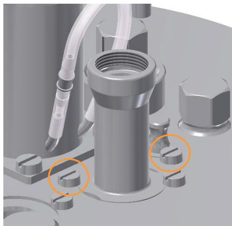
1. Insérer la protection pour la sonde pH dans le port de 19 mm correspondant.
