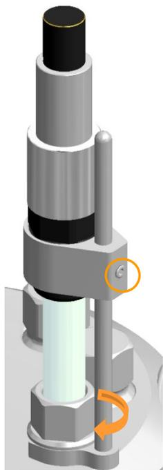
9. Visser la sonde au niveau de la vis creuse dans le port et serrer.
