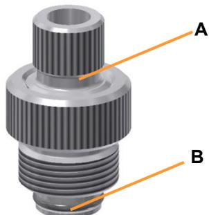
Une fois la vis à tête creuse (A) dévissée, le composant de Ø 12 mm peut être inséré dans le manchon de blocage ou retiré. Le serrage de la vis à tête creuse permet de le fixer dans le manchon de blocage.
