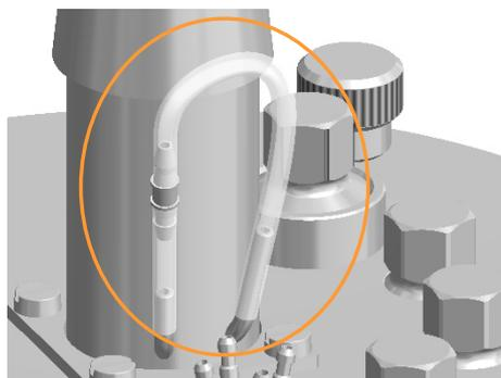
Pour cette raison, toujours vérifier et s'assurer que le tuyau en silicone au pied du moyeu d'entraînement est totalement rempli de glycérine. Au besoin, le remplir.
