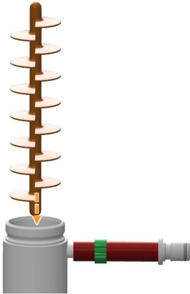
1. Introduire la chicane en silicone dans le condenseur de gaz de sortie.
