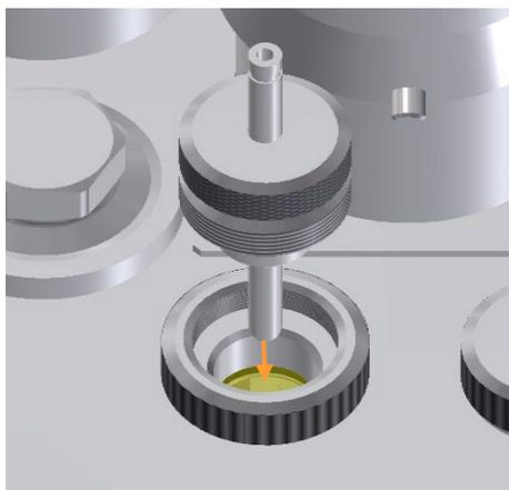
7. Visser l'aiguille d'inoculation dans la bague porte septum.
