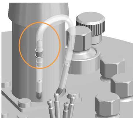
1. Retirer la partie longue du tuyau de l'accouplement de la partie courte du tuyau.
