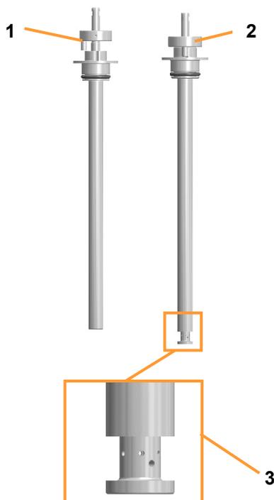
Afin d'éviter que le diffuseur ne soit bouché par les solides présents dans le milieu, le diffuseur de gaz est entouré d'une gaine stérile. Après la liquéfaction du milieu, le diffuseur de gaz est sorti et l'injection de gaz peut commencer.
