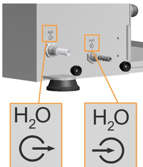
Les raccordements d'alimentation en eau et d'écoulement de l'eau se trouvent en bas à l'arrière de la console de l'appareil de base. Ils sont marqués des symboles correspondants :
