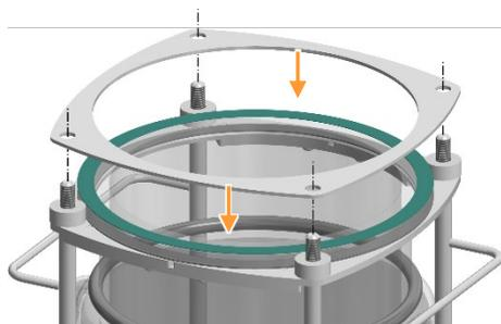
8. Positionner l'anneau en acier inoxydable sur les entretoises blanches. Insérer les tiges du support de cuve dans les trous de l'anneau en acier.
