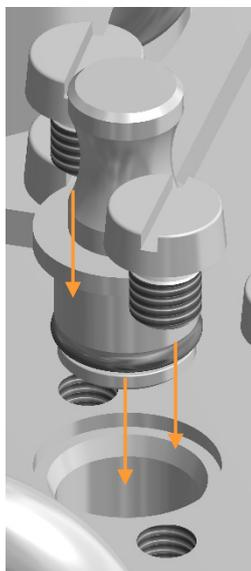
1. Insérer le bouchon avec joint torique fixe dans le port.
