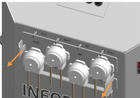
2. Retirer la platine avec les têtes de pompes des arbres d'entraînement en la tenant par les deux poignées.
