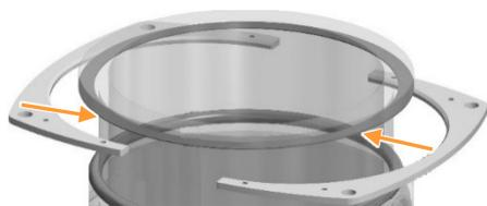
3. Placer les deux parties de la bride de la cuve sous le collier de la cuve et les maintenir dans cette position. Le bord biseauté des deux parties de la bride doit être orienté vers le haut.
