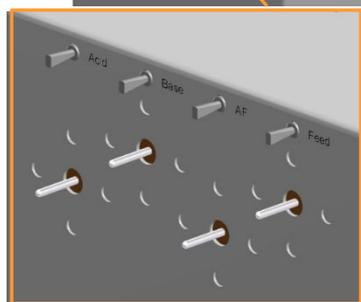
Lorsque l'appareil de base est en marche, les pompes peuvent être actionnées manuellement à l'aide des interrupteurs à bascule de la façon suivante :
