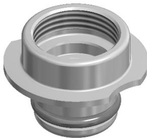
L'adaptateur est utilisé pour le montage des composants d'un diamètre de 12 mm sur un port (non fileté) de 19 mm dans le couvercle de la cuve.
