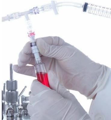
2. D'une main, tenir la vanne de prélèvement et, de l'autre, débloquer la seringue en la tournant.
