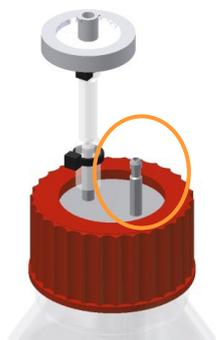
5. Insérer les tuyaux correspondants en silicone sur les raccords de tuyaux restés libres dans chaque flacon et les fixer à l'aide d'attache-câbles.
