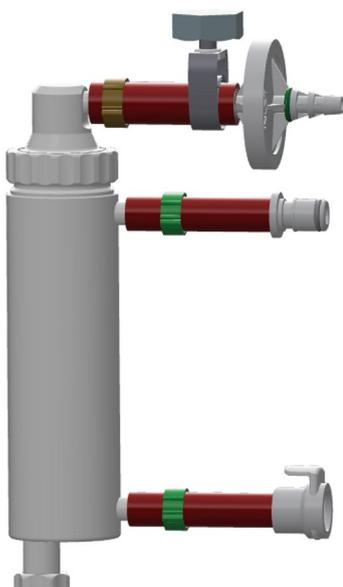
4. Equiper le tube de gaz de sortie d'un morceau de tuyau à pression (D = 8 x 14,5 mm) et d'un filtre de gaz de sortie propre et sec. Pour cela, insérer le côté entrée (INLET) avec le marquage vert dans le morceau de tuyau.
