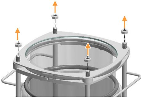
3. Desserrer et retirer à la main les quatre contre-écrous de l'anneau en acier inoxydable.
