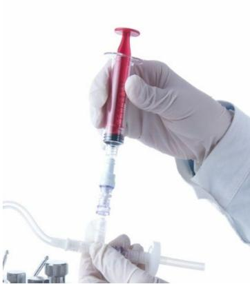
5. Tourner la seringue Luer-Lock pour la fixer sur la vanne de prélèvement.
