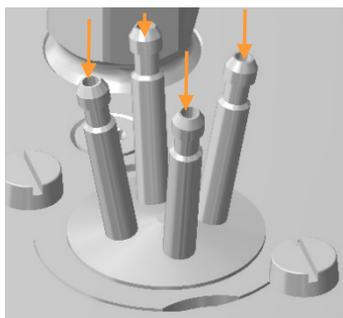
1. Enficher les tuyaux en silicone pour base, acide et ajout de substrat sur les inserts d'ajout et les fixer avec des attache-câbles.
