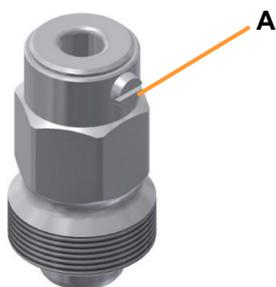
Une fois la vis à tête fendue (A) dévissée, le composant de Ø 6 mm peut être inséré dans le manchon de blocage ou retiré. Le serrage de la vis à tête fendue permet de le fixer dans le manchon de blocage.
