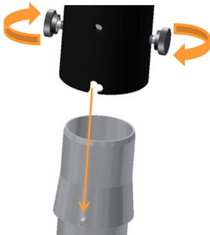
1. Enficher le moteur sur le moyeu d'entraînement, avec la rainure orientée vers la tige du moyeu d'entraînement.
