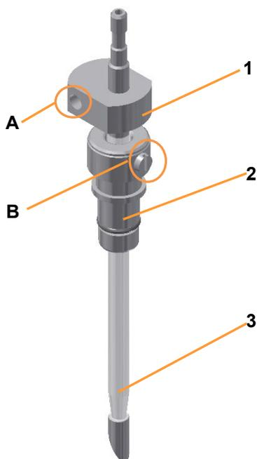
Si commandée, une sonde antimousse pour le montage dans un port de Ø 10 mm du couvercle de la cuve est fournie par défaut. Un manchon de blocage à joint torique fixe est utilisé pour le montage.
