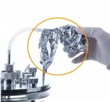
5. Recouvrir le système de vannes avec du papier aluminium, sans le fixer.
