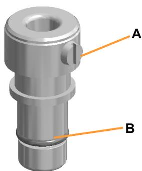
Une fois la vis à tête fendue (A) dévissée, le composant de Ø 6 mm peut être inséré dans le manchon de blocage ou retiré. Le serrage de la vis à tête fendue permet de le fixer dans le manchon de blocage.
