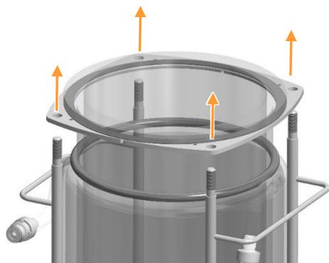
7. Soulever la cuve en verre du support sur la bride de la cuve en deux parties, respectivement l'enlever des tiges du support.
