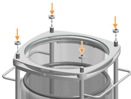
9. Fixer l'anneau en acier inoxydable avec les quatre contre-écrous. Visser les contre-écrous **à la main** en croix jusqu'à ce qu'ils touchent l'anneau en acier. **Ne serrer pas les vis et n'utiliser pas d'outils !**
