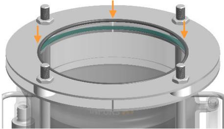
1. Contrôler le joint torique du couvercle pour vérifier l'absence de dommages et le positionnement correct : il doit être reposé sur le bord de la cuve, à l'angle du collier en métal.
