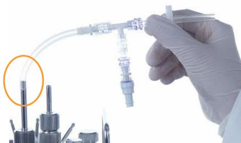
1. Enficher le tuyau du système de vannes sur le tube plongeant.
