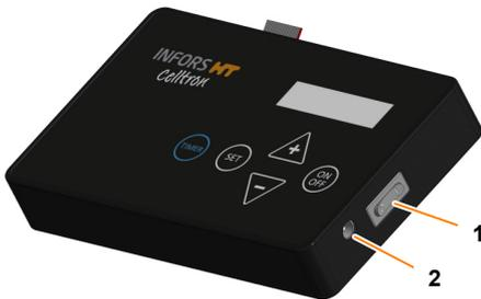
1. Asegúrese de que el interruptor del panel de operación (1) está en la posición *Off*.
