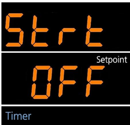
12. Appuyer sur la touche **ON/OFF** du panneau de commande inférieur pour allumer la fonction Timer.
