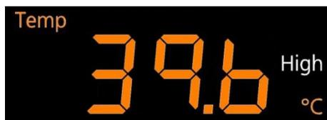
Une alarme de paramètre est déclenchée si la valeur réelle d'un paramètre s'écarte trop de la valeur de consigne après un temps d'attente donné. Dans l'exemple à gauche, la température est trop élevée.
