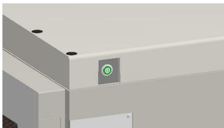
1. Appuyer sur l'interrupteur d'alimentation à l'avant du côté droit du boîtier, en haut.
