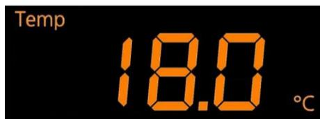
La commande du refroidissement s'effectue via le paramètre *Température*. L'affichage alphanumérique supérieur indique la valeur réelle en °C avec le symbole *Temp*.
