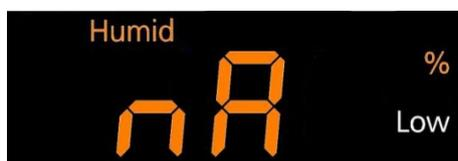
Pour éviter la condensation sur les parois intérieures, l'humidification à vapeur directe n'est activée que lorsque la valeur de consigne de la température réglée ( $\pm 1$  °C) est atteinte et stable pendant au moins 1 minute. Pendant le temps jusqu'à ce que la température soit stable, le message *nA* s'affiche.
