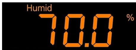
La commande de l'humidification directe à la vapeur s'effectue via le paramètre *Humidité de l'air*. L'affichage alphanumérique inférieur indique la valeur en % (humidité relative) avec le symbole *Humid*.
