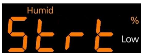
Après la mise en marche du paramètre, il faut environ 5 minutes pour que le générateur de vapeur se chauffe. Pendant le temps de chauffage, la valeur d'humidité réelle actuelle et le message *Strt* sont affichés en alternance.
