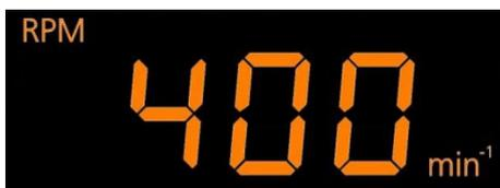
Le paramètre *Vitesse de rotation* est commandé via le panneau de commande. L'affichage indique à côté de la valeur réelle le symbole *RPM* et l'unité  $\text{min}^{-1}$ .
