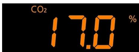
La commande de la régulation de CO<sub>2</sub> s'effectue via le paramètre CO<sub>2</sub>. L'affichage alphanumérique supérieur indique la valeur réelle en % avec le symbole CO<sub>2</sub>. Pour éviter la fuite de grandes quantités de CO<sub>2</sub>, la commande CO<sub>2</sub> s'éteint automatiquement lorsque la porte est ouverte.
