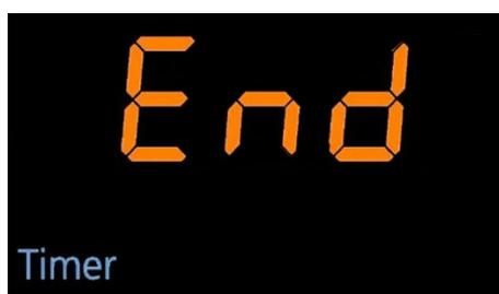
Après écoulement du temps saisi, le message *End* apparaît sur l'affichage alphanumérique inférieur. Toutes les 20 secondes, l'affichage revient aux valeurs réelles actuelles des paramètres. Une alarme sonore retentit en outre toutes les 60 secondes.
