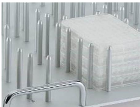
Pour les applications dans lesquelles de grandes quantités de plaques de microtitrage ou de plaques à puits profonds doivent être incubées, divers plateaux avec supports filetés sont disponibles. Ceux-ci permettent le chargement avec des plaques de microtitrage et des plaques à puits profonds en plusieurs couches.
