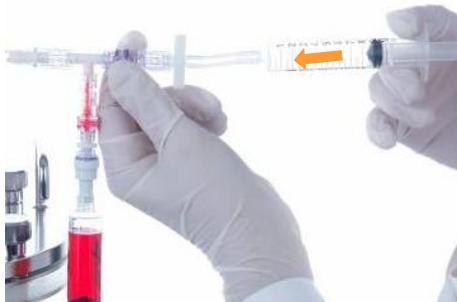
1. Spritze auf den Schlauch am Sterilfilter stecken und Luft durchdrücken.
