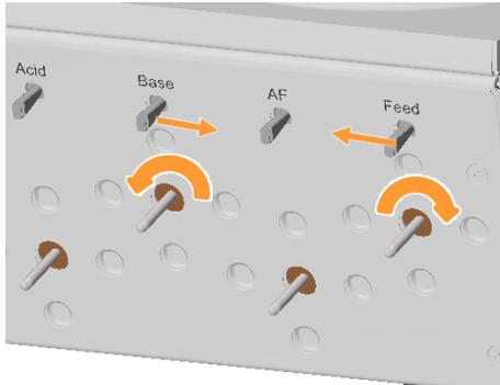
Bei eingeschaltetem Gerät lassen sich die Pumpen über die Wippschalter wie folgt manuell betätigen:
