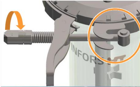
2. Mit einer Hand Schelle zusammendrücken und mit anderer Hand Gewindestange drehen und aushaken.
