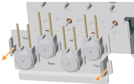
2. Montageplatte mit Pumpenköpfen an beiden Griffen von Antriebswellen abziehen.
