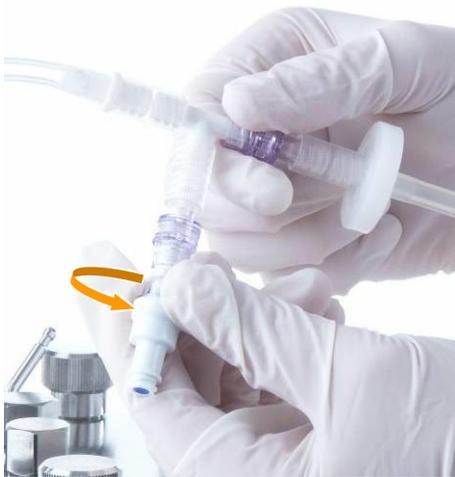
3. Probenahmeventil vorsichtig mit der Hand im Uhrzeigersinn festdrehen.
