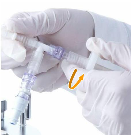
4. Sterilfilter vorsichtig mit der Hand im Uhrzeigersinn drehen.
