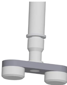
4. Flachdichtung an Magnetkupplung anbringen und Magnetkupplung von Hand im Uhrzeigersinn an Rührwelle schrauben.
