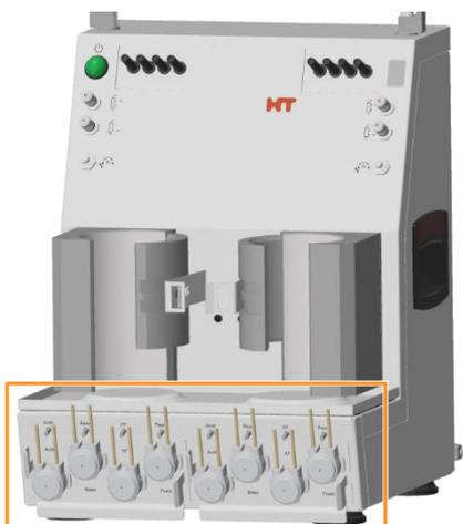
Korrekturmittel und Nährlösung werden über vier Peristaltikpumpen pro Kulturgefäß zugegeben. Die Pumpen werden von Schrittmotoren angetrieben. Die Antriebswellen der Pumpen befinden sich unten an der Vorderseite des Grundgeräts. Die Drehrichtung ist standardmäßig gegen den Uhrzeigersinn. Wippschalter für eine manuelle Betätigung der Pumpen befinden sich oberhalb der Antriebswellen. Sie sind von links nach rechts wie folgt beschriftet:
