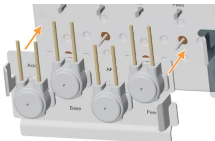
1. Montageplatte mit Pumpenköpfen aus Halterung am Gefäßhalter ziehen.
