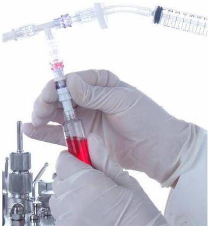
2. Probenahmeventil mit einer Hand festhalten, mit der anderen Hand die Spritze abdrehen.
