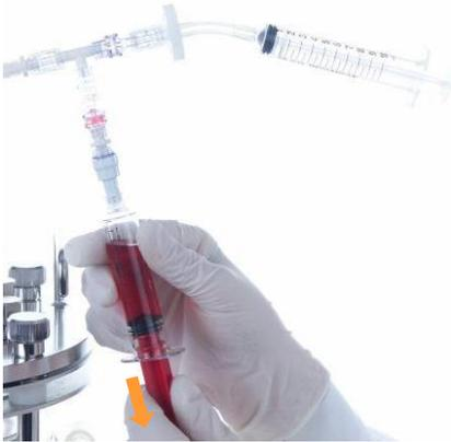
1. Spritze mit der Probe nach unten halten, Kolben zurückziehen.
