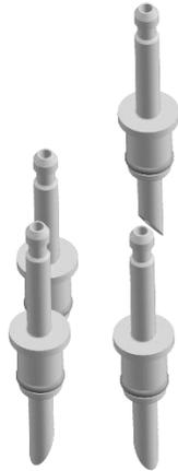
Die vier Zugabestutzen dienen der Zugabe von Flüssigkeit in das Kulturgefäß und enden im Kopfraum des Gefäßes. Sie verfügen über einen Schlauchanschluss, sind mit festem O-Ring bestückt und werden in die vier 7,5 mm Ports im Deckel montiert. Die Zugabestutzen sind unten schräg angespitzt und deren Längsseiten sind in montiertem Zustand nach außen gerichtet. Zur Fixierung aller vier Zugabestutzen dient der Schlauchhalter.
