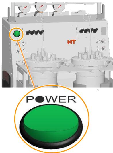
Der Netzschalter, ein grüner Wippschalter, befindet sich vorne links am Grundgerät. Er ist mit **POWER** beschriftet und leuchtet sobald das Gerät eingeschaltet ist. Neben dem normalen Ein- und Ausschalten dient der Netzschalter auch als Notschalter.
