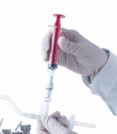
6. Kolben der Spritze zurückziehen, um gewünschtes Probevolumen zu entnehmen.
