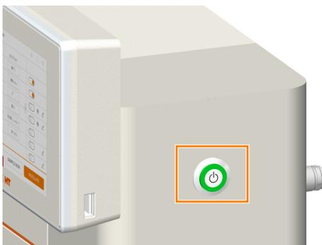
El interruptor de alimentación se encuentra en el lado derecho de la unidad básica. Además de para la conexión y desconexión habitual, el interruptor de alimentación también sirve como interruptor de emergencia.
