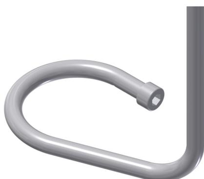
El gas se introduce directamente en el medio a través de un rociador de anillo ( $\varnothing$  6 mm) con orificios distribuidos uniformemente en la parte inferior del anillo, a través de los cuales burbujea aire/gas en el medio de cultivo.
