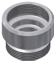
El collar del septum con rosca interior se utiliza para la inoculación del cultivo y en combinación con la jeringa, la aguja de inyección y el septum (→ Capítulo 4.21 «Accesorios de inoculación y herramientas» en la página 73). El collar del septum se utiliza para fijar el puerto de 12 mm/Pg13,5.
