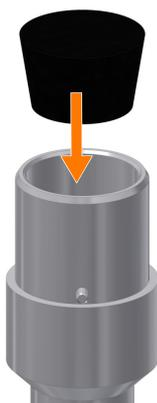
A rolha cônica (EPDM) contido no kit básico protege o cubo de transmissão da agitação contra a entrada de condensação durante a esterilização na autoclave.
