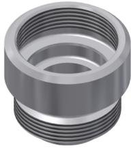
O colar de fixação do septo com rosca interna é utilizado para a inoculação da cultura e em combinação com de seringa, agulha de injeção e septo (→ Capítulo 4.21 “Acessório pontiagudo e ferramenta” na página 72). O colar de fixação do septo serve para a fixação do septo na porta de 12 mm/Pg13,5.
