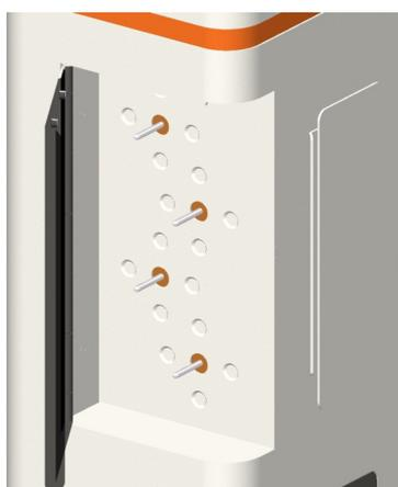
O reagente e o meio de cultivo (Feed) são adicionados através de quatro bombas peristálticas. As bombas são acionadas por motores de passo. Os eixos de acionamento das bombas estão localizados no lado esquerdo do dispositivo básico. Por padrão, o sentido de direção dos eixos de acionamento para a função "Encher" é anti-horário, conforme a marcação na placa de montagem.
