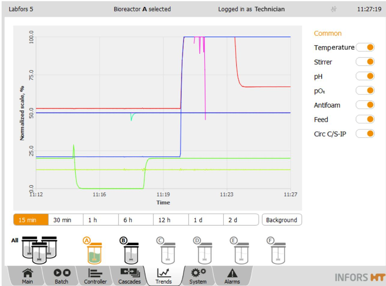
Die Touchscreen Bedieneinheit behält die aktuellen Werte der Parameter in einem Zwischenspeicher und stellt diese im Hauptmenü *Trends* laufend als Diagramm dar. Diese Daten können weder archiviert, noch bearbeitet oder exportiert werden. Das Hauptmenü *Trends* bietet lediglich einen schnellen Überblick über den Verlauf der Kultivierung. Bei Auswahl aller Bioreaktoren (*ALL*) ist dieses Menü nicht verfügbar.
