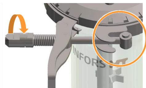
2. D'une main, appuyer le collier et de l'autre main, tourner la tige filetée et la décrocher.
