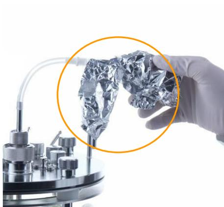
5. Recouvrir le système de vannes avec du papier aluminium, sans le fixer.
