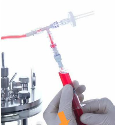
6. Tirer le piston de la seringue en arrière pour prélever le volume d'échantillon souhaité.
