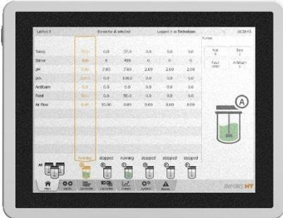
La console de commande a un écran tactile couleur 12" avec protection IP66.
