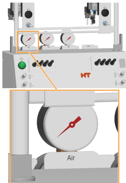
A l'avant de l'appareil de base, les manomètres sont également clairement étiquetés avec le gaz correspondant.
