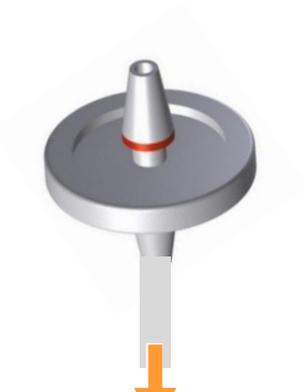
3. Enficher le tuyau en silicone sur le diffuseur de gaz.
