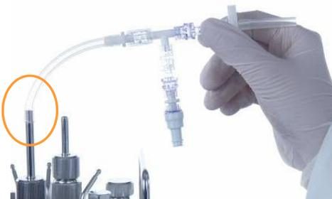
2. Fixer le tuyau à l'aide d'attache-câbles.
