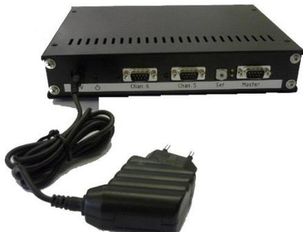
La Switchbox sérielle du fabricant d'appareil est utilisée pour connecter les balances de laboratoire au bioréacteur. Il est possible de connecter jusqu'à sept balances et de transmettre ainsi des données mesurées. Des échelles pré-configurées correspondantes sont disponibles en option. Les réglages requis dans le logiciel pour écran tactile doivent être effectués par un technicien du service après-vente INFORS HT.
