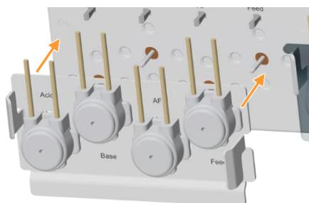
1. Tirer la platine des têtes de pompes pour la sortir de la fixation au niveau du support de cuve.
