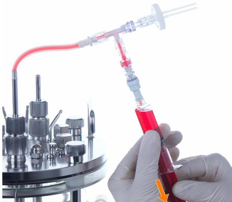
6. ➤ Kolben der Spritze zurückziehen, um gewünschtes Probevolumen zu entnehmen.
