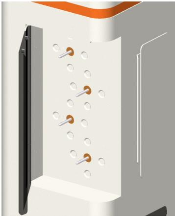
Korrekturmittel und Nährlösung (Feed) werden über vier peristaltische Pumpen zugegeben. Die Pumpen werden von Schrittmotoren angetrieben. Die Antriebswellen der Pumpen befinden sich an der linken Seite des Grundgeräts. Die Drehrichtung der Antriebswellen ist für die Funktion "Füllen" standardmässig gegen den Uhrzeigersinn, siehe Markierung auf der Montageplatte.
