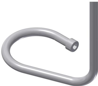
Der direkte Gaseintrag ins Medium erfolgt über einen Ring-Sparger (Ø 6 mm) mit gleichmässig verteilten Bohrungen an der Unterseite des Rings, durch die Luft/Gas in das Kulturmedium perlt.
