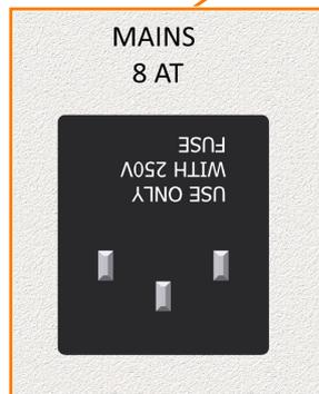
Der Netzanschluss befindet sich auf der Rückseite links unten am Grundgerät. Das Gerät ist mittels zwei Schmelzsicherungen vor unzulässig hoher Stromaufnahme geschützt. Die Gerätesicherungen befinden sich unmittelbar über dem Netzanschluss. Das für den Anschluss an der Stromversorgung nötige länderspezifische Netzkabel ist im Lieferumfang des Geräts enthalten. Bei einem Defekt das Netzkabel ausschliesslich durch ein gleich bemessenes Netzkabel ersetzen.
