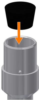
Der im Starter-Set enthaltene konische Stopfen (EPDM) schützt die Antriebsnabe vor Eindringen von Kondenswasser während der Sterilisation im Autoklav.
