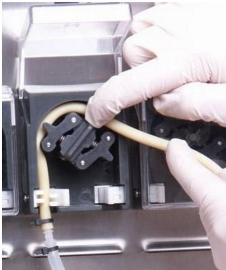
4. ➤ Pumpenschlauch um den Pumpenkopf legen und leicht hineindrücken.
