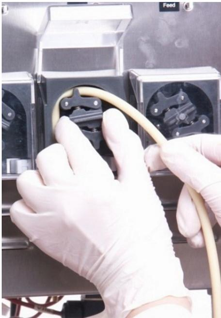
5. ➤ Pumpenkopf mit einer Hand langsam im Uhrzeigersinn drehen und mit anderer Hand die Führung des Pumpenschlauchs unterstützen.
