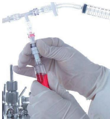
2. D'une main, tenir la vanne de prélèvement et, de l'autre, débloquent la seringue en la tournant.
