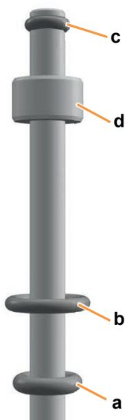
4. S'assurer que les trois joints toriques (a - c) et le palier de l'arbre d'agitation (d) ne se perdent pas.
