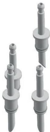
Les quatre inserts d'ajout servent à ajouter du liquide dans la cuve de culture et ils se terminent dans l'espace de tête de la cuve. Ils disposent d'un raccord pour tuyau, sont équipés d'un joint torique et sont montés dans les quatre ports de 7,5 mm du couvercle.
