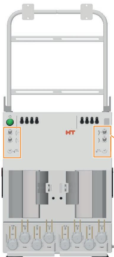
Les raccordements d'alimentation en eau pour le condenseur de gaz de sortie et la vanne de régulation pour le débit d'eau se trouvent à gauche et à droite à l'avant de l'appareil de base. Les vannes sont réglées en usine. Au besoin, le débit d'eau peut être réglé manuellement sur les vannes. Les vannes peuvent être laissées aux positions souhaitées à l'aide d'un contre-écrou.
