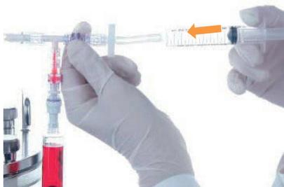
1. Enfoncer la seringue sur le tuyau du filtre stérile et appuyer pour faire sortir l'air.
