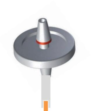
3. Enficher le tuyau en silicone sur le diffuseur de gaz.
