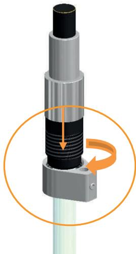
4. Introduire la sonde dans la vis creuse (filetage vers le bas).
