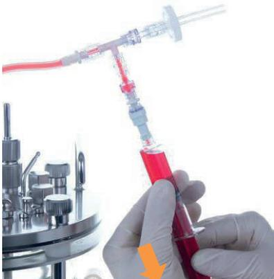
6. Tirer le piston de la seringue en arrière pour prélever le volume d'échantillon souhaité.
