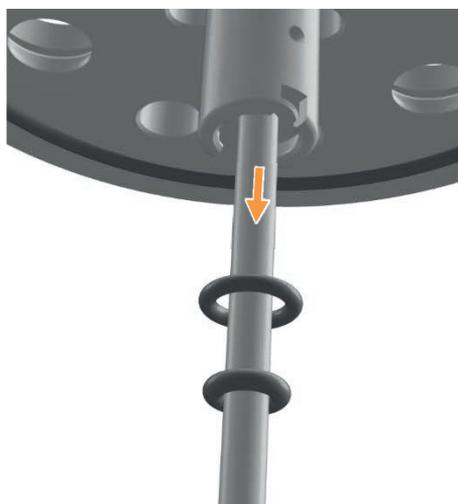
3. Retirer avec précaution l'arbre d'agitation du logement de roulement.
