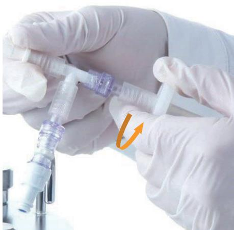
4. Tourner le filtre stérile à la main, avec précaution, dans le sens des aiguilles d'une montre.
