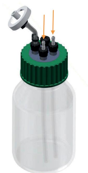
6. Fermer les tuyaux en silicone avec des pinces pour tuyaux souples au plus près des raccords de tuyaux des flacons de réactif, de sorte qu'aucun réactif ne puisse s'écouler dans la cuve de culture.
