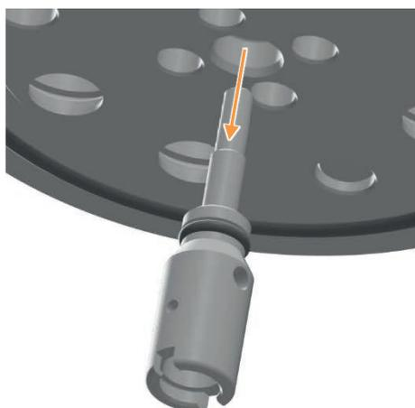
1. Tirer le logement de roulement hors du couvercle par le bas.
