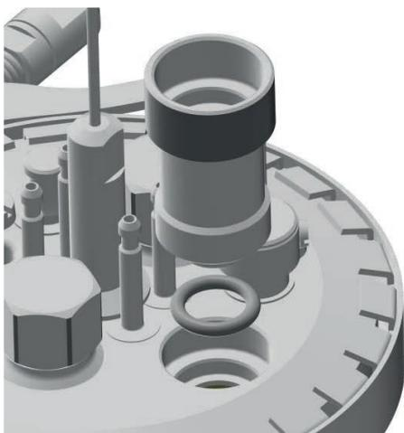
1. Équiper la douille adaptateur d'un joint torique.
