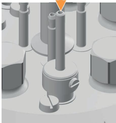
4. Fixer les extrémités du tuyau à l'aide d'attache-câbles.
