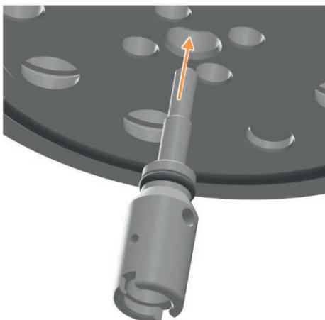
1. Insérer le logement de roulement équipé d'un joint torique dans l'ouverture au milieu du couvercle.
