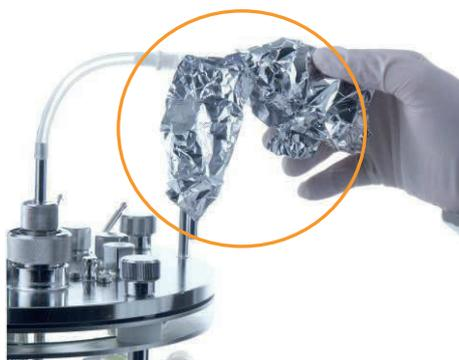
5. Recouvrir le système de vannes avec du papier aluminium, sans le fixer.
