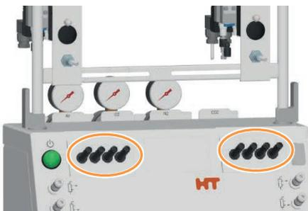
L'appareil de base est équipé et configuré pour la mesure de la température, du pH, du pO<sub>2</sub> et la détection de mousse (« anti-mousse ») par défaut. Cela veut dire que les sondes températures et les câbles des sondes pH, pO<sub>2</sub> et antimousse sont toujours présents. Les sondes antimousses appropriées sont incluses dans les packages standard, les sondes pH et pO<sub>2</sub> sont disponibles séparément.
