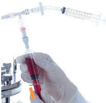
1. Maintenir la seringue avec l'échantillon vers le bas, tirer le piston vers l'arrière.
