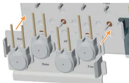
2. Insérer la platine avec les têtes de pompes sur les arbres d'entraînement.
