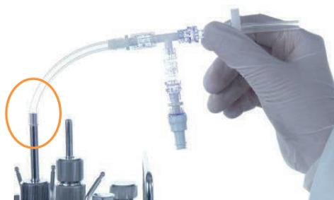
2. Fixer le tuyau à l'aide d'attache-câbles.
