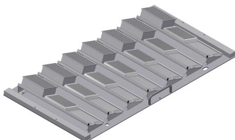
Plateau avec pinces inclinées avec un angle de 20° (incubation inclinée) : la barre de serrage inclinée est une tôle en forme de plaque avec deux profilés. Le profilé inférieur est une barre coudée (3). Le profilé supérieur est un profilé en U dans lequel un cordon en caoutchouc cellulaire (2) est inséré. Deux entretoises (1) se trouvent sur le profilé supérieur afin de positionner les plaques de microtitration ou les plaques à puits profonds.
