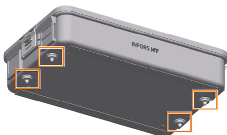
La boîte pour plaques de microtitration est fixée au plateau par quatre vis cruciformes. À la livraison, les vis de fixation sont recouvertes d'écrous borgnes en plastique. Ceux-ci doivent être retirés avant le montage.
