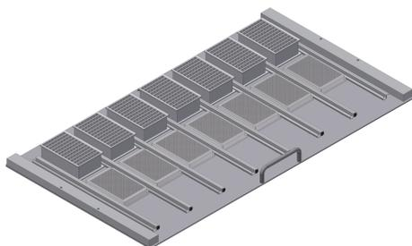
Plateau avec pinces plates (incubation horizontale) : la pince plate est un profilé en tôle qui est équipé d'un côté d'une barre coudée (2). De l'autre côté se trouve un bord avec un cordon en caoutchouc éponge (3). Deux entretoises (1) se trouvent sur le bord afin de positionner les plaques de microtitration ou les plaques à puits profonds.
