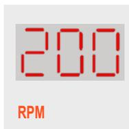
Le mécanisme d'agitation est commandé par le paramètre « Vitesse de rotation » (RPM, Rotations Per Minute). Pour plus de détails sur le réglage des paramètres, voir → Chapitre 6.3 « Régler, activer et désactiver les paramètres » à la page 64.
