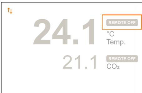
Wird das Gerät über eve® angesteuert, wird dies am Gerät wie folgt angezeigt:
