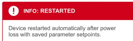
Unter den Parameteranzeigen befindet sich ein separates Feld, in dem Alarmer sowie Fehlermeldungen in roten Infoboxen angezeigt werden. Die Infoboxen beschreiben den Alarm bzw. Fehler (➔ Kapitel 8 «Störungsbehebung» auf Seite 92).
