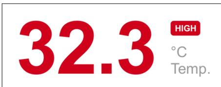
Ein Parameter-Alarm wird dann ausgelöst, wenn der Istwert eines Parameters nach einer vorgegebenen Wartezeit zu stark vom Sollwert abweicht. Im Beispiel links ist die Temperatur zu hoch. Die maximal zulässige Abweichung vom Sollwert und die Wartezeit sind werkseitig eingestellt und können nicht verändert werden.
