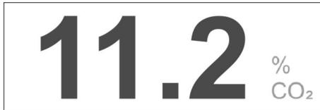
Die Bedienung der CO<sub>2</sub>-Regelung erfolgt über den Parameter "CO<sub>2</sub>" (CO<sub>2</sub>). Um das Austreten von grossen Mengen CO<sub>2</sub> zu verhindern, wird die CO<sub>2</sub>-Regelung automatisch ausgeschaltet, während die Tür geöffnet ist.
