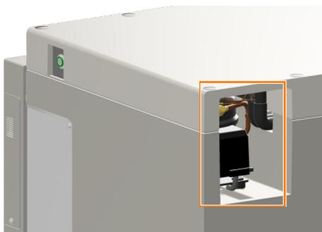
Für Prozesse, die tiefe Temperaturen erforderlich machen, kann das Gerät mit einer Kühleinheit ausgestattet werden. Die Kühleinheit ist auf der Rückseite des Geräts, von vorn gesehen, oben rechts eingebaut. Mit der Kühlung können Temperaturen von bis zu 16 °C unter der Umgebungstemperatur, minimal aber 4 °C erreicht werden.
