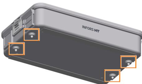
A caixa para microplacas é fixada na bandeja com quatro parafusos Phillips. Na entrega, os parafusos de fixação estão cobertos com porcas de capa de plástico. Elas devem ser removidas antes da montagem.
