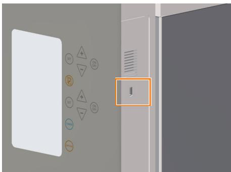
A porta USB no lado direito do painel de controle é reservada para fins de manutenção e não tem função em operação normal.
