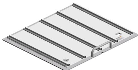
Bandeja com conjuntos de fixação de garras planos (incubação horizontal): o conjunto de fixação de garras plano é um perfil formado por chapa, equipado com uma barra angular (2) em um dos lados. Do outro lado há uma borda que é forrada com um cordão de espuma de borracha (3). Existem dois espaçadores (1) na borda para posicionar as microplacas ou placas de poços profundos.
