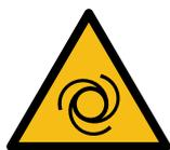
Componentes móveis sempre representam um perigo proveniente do dispositivo, pois partes do corpo podem ser esmagadas ou arranhadas se não houver cuidado.
