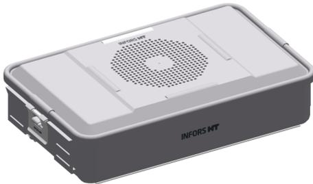
A caixa para microplacas é usada para cultivo de baixa evaporação em microplacas e placas de poços profundos. Ela protege as culturas de correntes de ar na câmara de incubação e também fornece um recipiente estéril para transportar as culturas.
