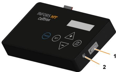
1. Sicherstellen, dass sich der Kippschalter an der Bedieneinheit (1) in Position *Aus* befindet.
